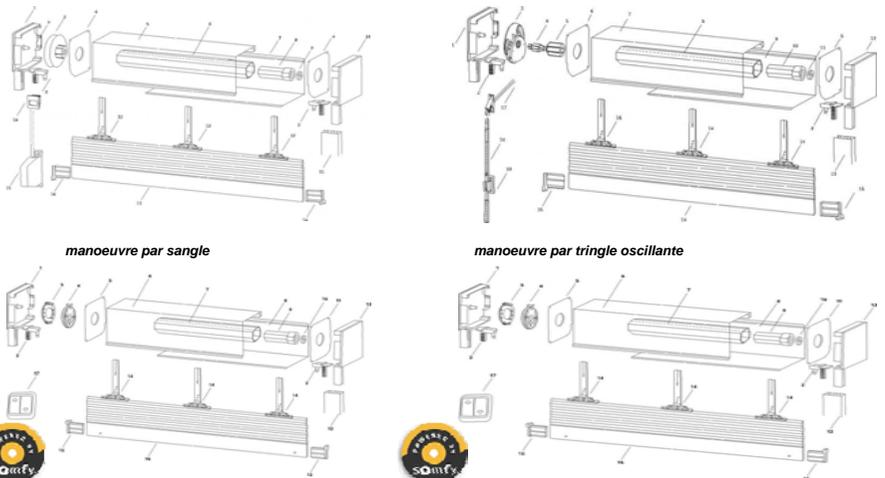
**manoeuvre par sangle**      **manoeuvre par tringle oscillante**
